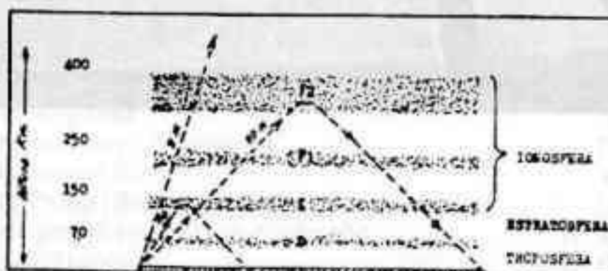
Fig. 2 - Posición aproximada de las diversas capas de reflexión ionosférica.
