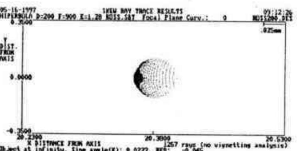
Fig. 8: Espejo hiperbólico con corrector, imagen a 20mm del eje óptico.
