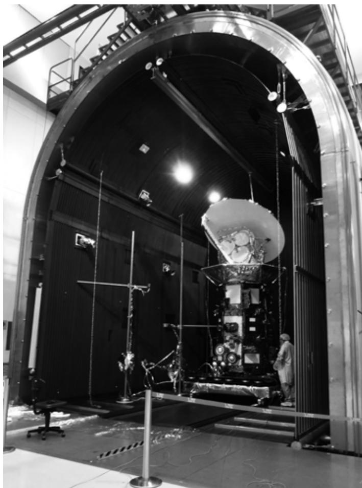
El satélite SAC-D está siendo introducido en una enorme cámara de termovacío para ser ensayado. Laboratorio de Integración y Testeo (San Pablo, Brasil).
