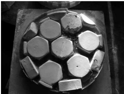
El próximo paso será hacer un molde de caucho de silicona de todos los hexágonos en su posición para obtener el molde en una sola pieza; así no habrá piezas pegadas que se puedan echar a flotar. De todos modos, si es que la situación no empeora -como podría ser que el vidrio se derrame del molde o algo así- continuaré la horneada para observar los resultados en cuanto a burbujas y tensiones internas.
