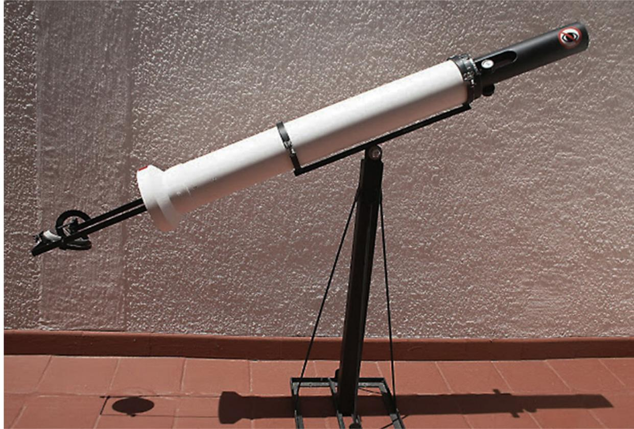
El telescopio que se observa en la fotografía se elaboró con un telescopio refractor acromático de 60 mm. de objetivo y 700 mm. de focal, alojado concéntricamente dentro de un tubo de PVC que sirve de soporte al espejo y que además puede girar sobre su eje deslizándose sobre las abrazaderas de la montura.
