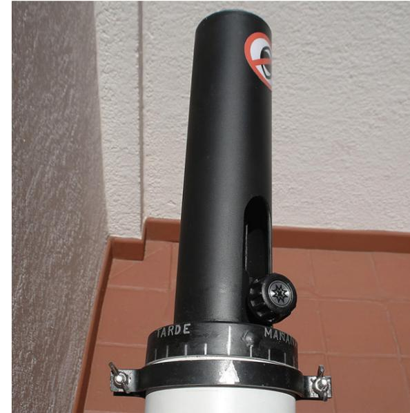
A fin de facilitar el posicionamiento gradué sobre el tubo con una marca larga cuando el espejo se encuentra hacia arriba horizontal indicando la posición del mediodía solar y hacia ambos lados la mañana y tarde con marcas cada hora (cada 15°).
