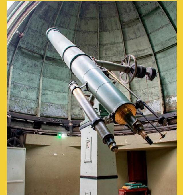
**Telescopio Ecuatorial.** Telescopio refractor con montura ecuatorial fabricada por Warner & Swasey. Este instrumento se empleó primeramente con un objetivo fotográfico. El «Ecuatorial», ubicado en la cúpula noreste del edificio, hoy es empleado para la atención al público. Foto: Observatorio Nacional de Córdoba.
