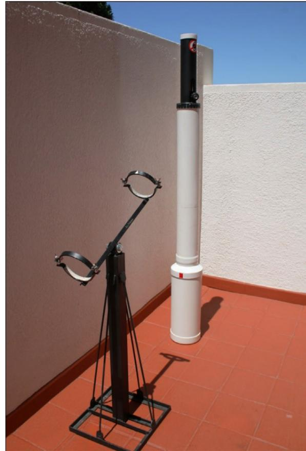
Vista del telescopio desmontado con la tapa protectora del ocular y el capuchón que cubre el espejo plano pivotante.
